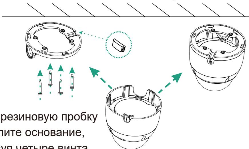
3 Выньте резиновую пробку и закрепите основание, используя четыре винта.
