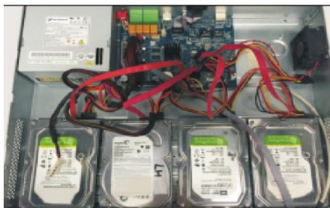
Шаг 4: Совместите отверстия для винтов на жестком диске с отверстиями для винтов на нижней пластине и закрепите жесткий диск винтами.
