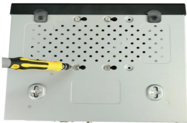
Шаг 5: Закройте верхнюю крышку и закрепите ее винтами.
