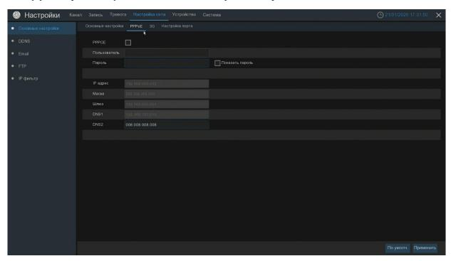
Во вкладке «Настройки порта» можно изменять используемые порты, включать функцию UPNP (функция автоматического проброса портов) для нужного порта. Так же в этом разделе включается доступ регистратора к облаку.
