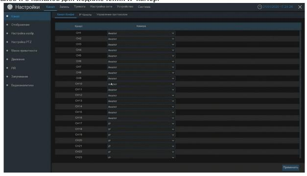
Во вкладке «IP каналы» происходит поиск, добавление и удаление IP камер. Для добавления камеры нажмите кнопку поиск. Регистратор покажет все найденные в сети ір- адреса. Выберите нужный адрес и нажмите кнопку добавить. Так же можно добавить все найденные
