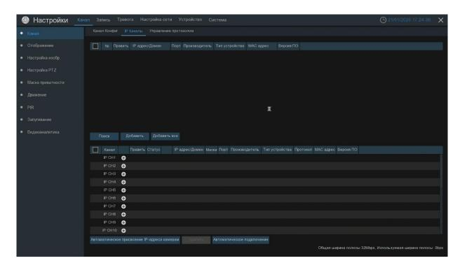
Во вкладке «Управление протоколом» можно настроить клиентский протокол для работы с IP камерой по RTSP потоку. Указывается номер порта и URL ссылка на поток.
